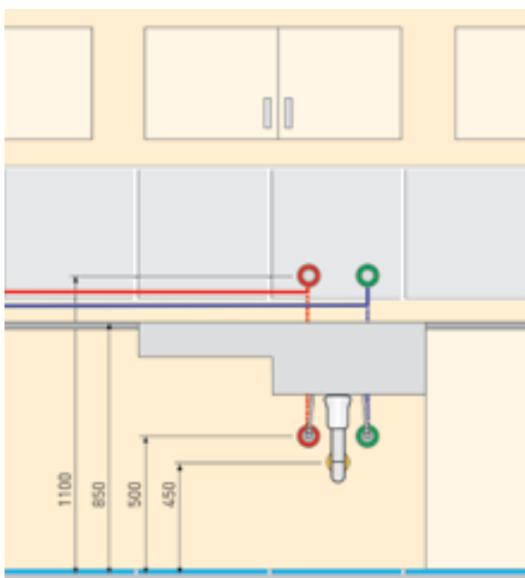
Присоединительные размеры для мойки на кухне
